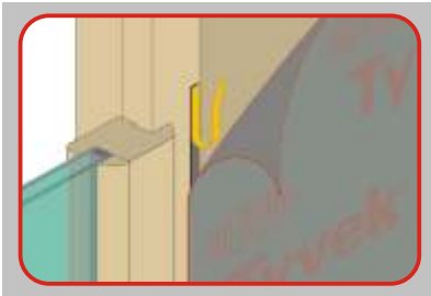
figura E lipirea membranei la zona de contact a ferestrei cu peretele
